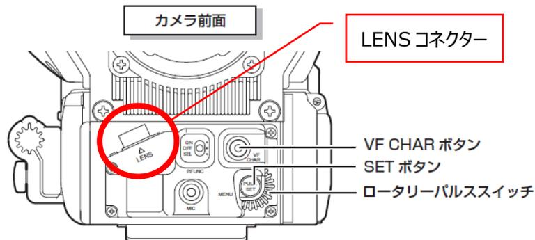
ただしレンズへの給電を外部とした場合でも、カメラからのレンズコントロール(アイリスなど)が必要なため、LENS コネクターの接続は必要です。レンズへの給電のみ外部からに切替での運用をお願い致します。レンズの給電変更については、レンズの取扱説明書等の参照をお願い致します。
