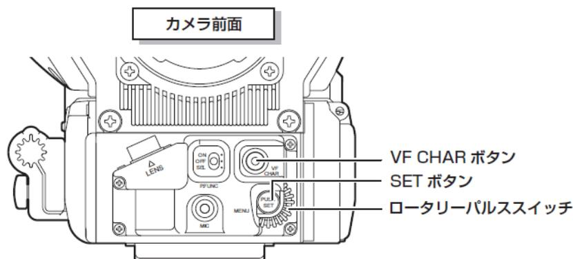
カメラ前面にある VF CHAR ボタンを押しながら、SET ボタンを押すと、ビューファインダーに簡易メニューが表示されます。(カメラヘッド内 MPU モジュールのスイッチ (S10-6) が ON になっている場合、簡易メニューではなく MENU (1/3) が表示されます。)
