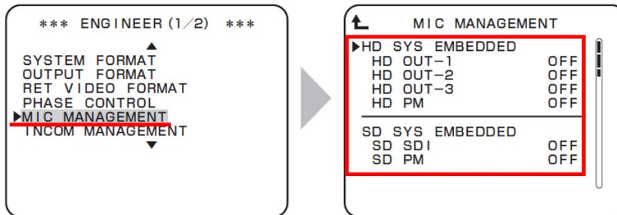
「HD SYS EMBEDDED」及び「SD SYS EMBEDDED」にて、ご希望の出力項目の ON/OFF 設定をします。
