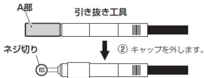
3. 引き抜き工具をアライメントスリーブに差し込み、時計回りに8～10回ほどまわし、先端の回転が止まったら、まっすぐに引き抜きます。
