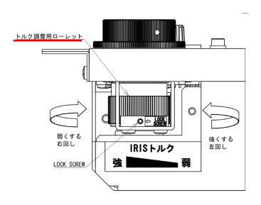
トルクを重たくする場合は"左"に回し調整してください。軽くする場合は"右"に回し調整してください。 出荷時は、一番軽い状態(右回し一杯)となっています。
