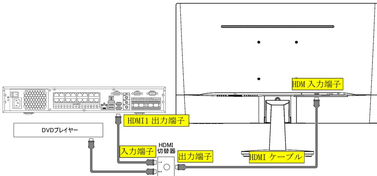
(6) HDMI 切替器の切替がレコーダーからの入力が出力されていることを確認する。違う入力を選択されている場合は、HDMI 切替器のボタンを押して切り替える。
