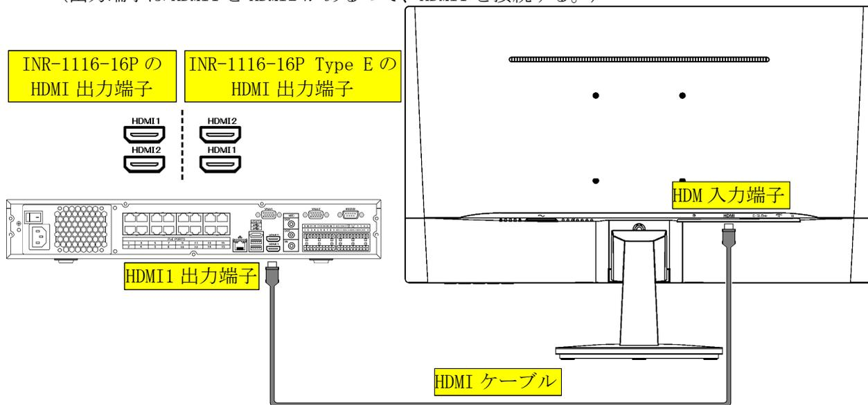
(5) HDMI ケーブルの接続を確認する。HDMI 切替器が入っている場合。
