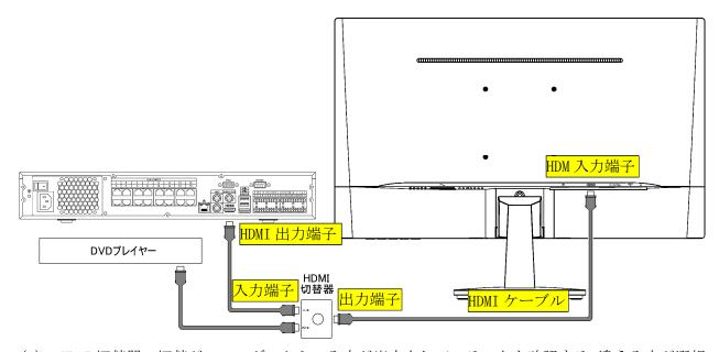
(6) HDMI 切替器の切替がレコーダーからの入力が出力されていることを確認する。違う入力が選択されている場合は、HDMI 切替器のボタンを押して切り替える。
