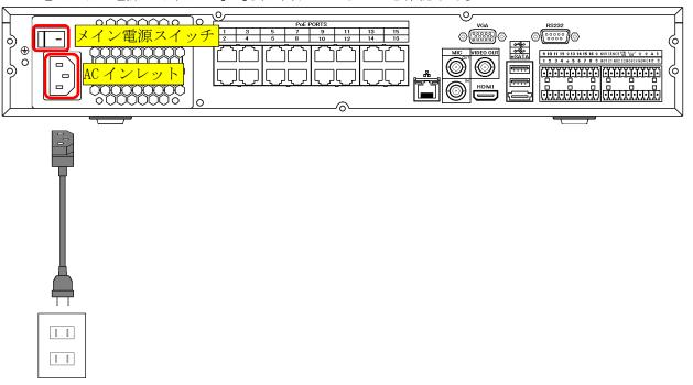
(3) 電源ケーブルの接続が正常で、メイン電源スイッチが ON でも電源が入らない場合は、 レコーダーの電源故障が疑われる。 (4) HDMI ケーブルの接続を確認する。
