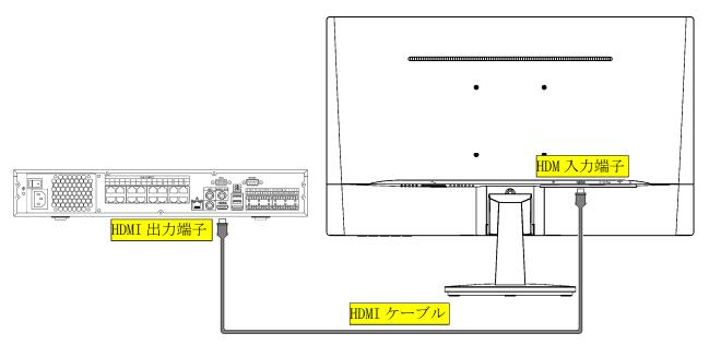
(5) HDMI ケーブルの接続を確認する。HDMI 切替器が入っている場合。
