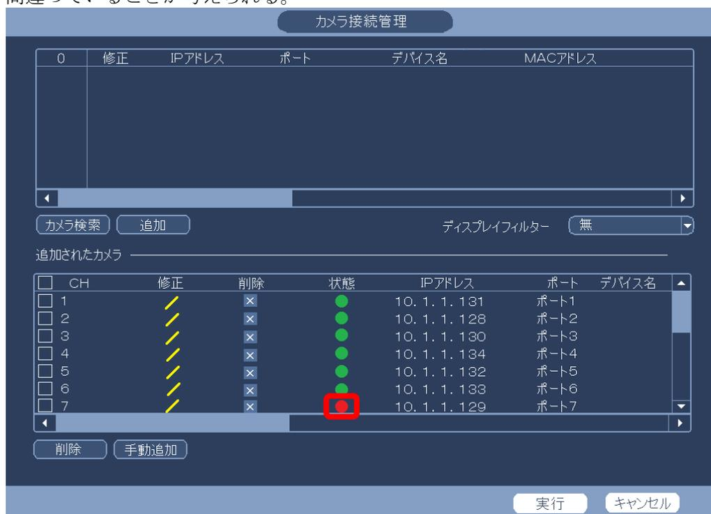
状態が[●]表示でカメラ映像が表示されていない場合は、カメラの映像設定が0になっていることが考えられる。
